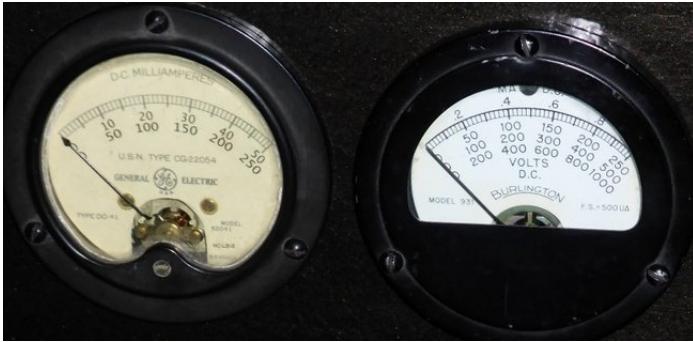
De twee meters voor stroom en spanning
